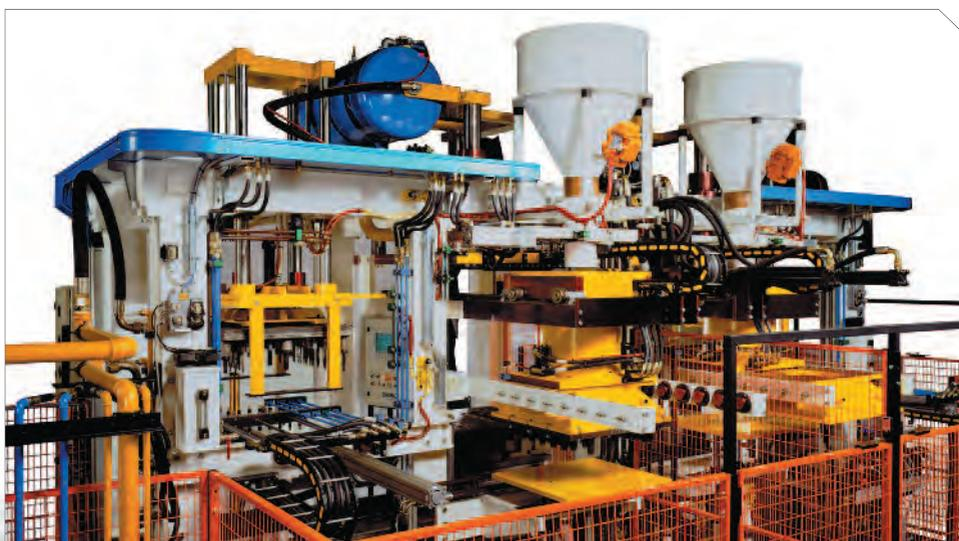
► Impianto automatico per la formatura di gusci - Automatic plant for the production of shell moulds
