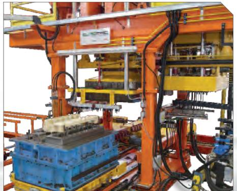
► Spara anime automatica tipo SPF 30R • Automatic core making machine type SPF 30R
