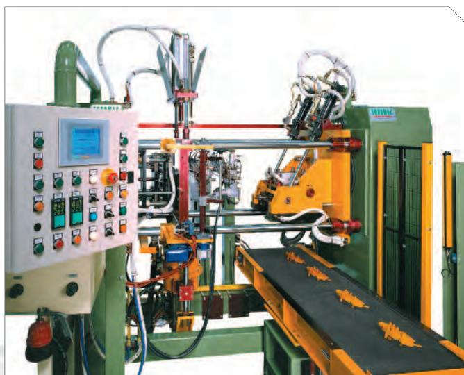
► Spara anime tipo SPF 50 • Core making machine type SPF 50
